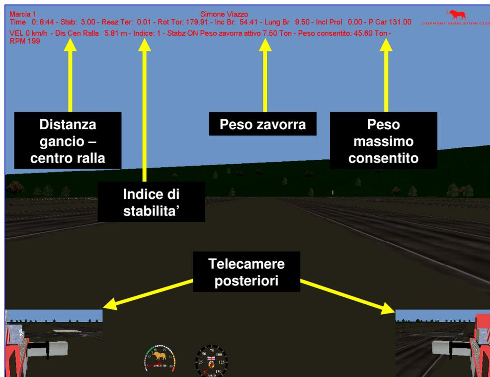
**Figura 33 - Parametri di stabilità a monitor**
